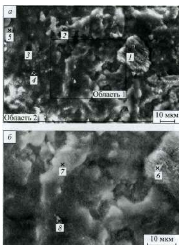
Рис. 3. Структура фарфора ФПН-5 (а, \times 1000 ), увеличение области 1 (б, \times 2000 )
