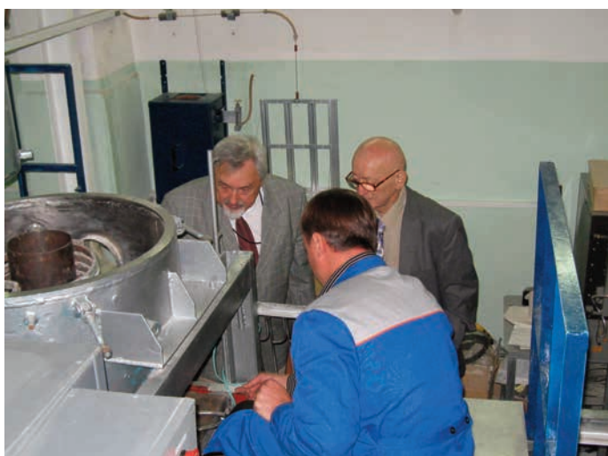
Монтаж индукционной печи в Центре оптического стекла. В. Н. Сигаев, П. Д. Саркисов
