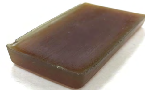
Образец композиционного наноматериала полиэфирной смолы, содержащей воду и 5% наночастиц ZnO (50 нм)
