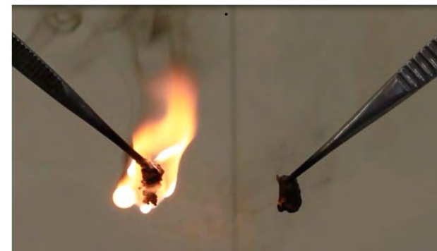
Горение чистого полимера ПВХ (слева) и нанокompозита на его основе (справа)
