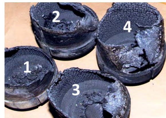
Образцы коксового остатка ЭС, содержащей штатный наполнитель (1,2,3) и наночастицы гидроксида магния и ПФА (4) ФЦДТ «Союз».
